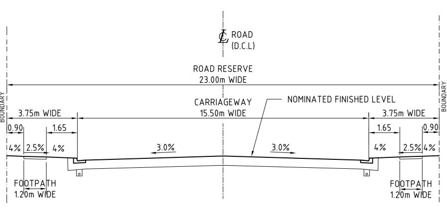
TYPICAL CROSS-SECTION - COLLECTOR ROAD B
